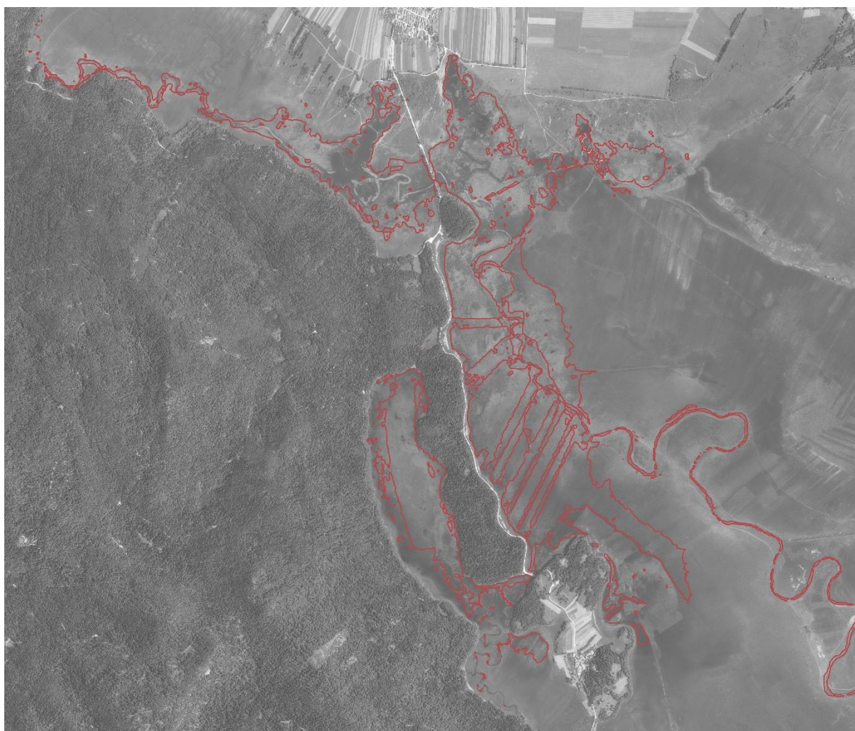
Slika 11: Plastnica za vodostaj na merilni postaji Dolenje Jezero – Stržen pri 240 cm.
